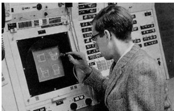
Рисунок 11 – Система скетчпада с сенсорным экраном и оптическим стилусом
